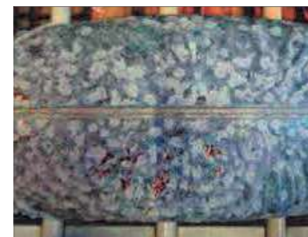
De bochten na zes dagen zoutneveltest. Rechts vertoont het vermoedelijke Z140-materiaal reeds rode roest
