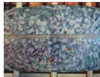
Les coudes après six jours de test de brouillard salin. A droite, le matériau supposé Z140 montre déjà de la rouille rouge
