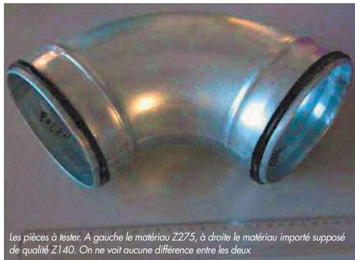
Les pièces à tester. A gauche le matériau Z275, à droite le matériau importé supposé de qualité Z140. On ne voit aucune différence entre les deux
